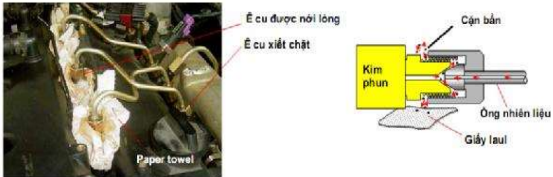
Hình 5.19. Xả nhiên liệu và cặn bẩn ra khỏi ống cao áp và vòi phun.
