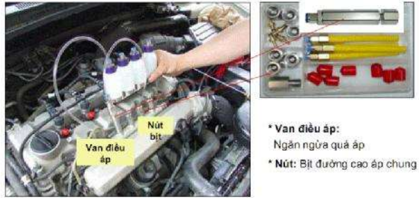
Hình 5.13. Lắp đặt đồng hồ cao áp.
