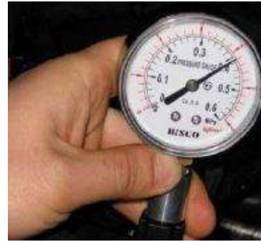
Hình 5.8. Lắp đồng hồ đo áp suất thấp.
