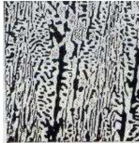
Hình 2.14 : Tổ chức tế vi của gang trắng cùng tinh ( %C =4,3 )
