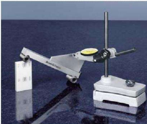
Hình 3.25: Cấu tạo của thước sin
