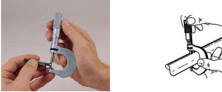
Hình 3.13. Sử dụng Panme đo ngoài để đo đường kính chi tiết
