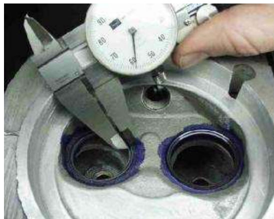
Hình 3.23: Kiểm tra ổ đặt bằng thước cặp
