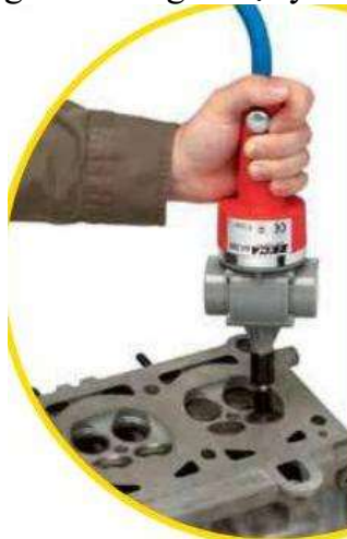
Hình 3.21: Thử độ kín xu páp bằng không khí
