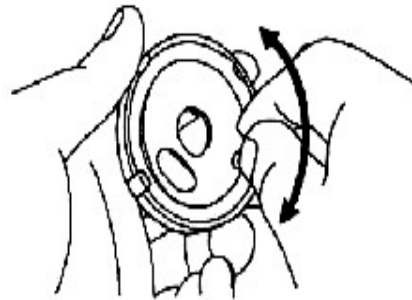
Hình 6.12 Kiểm tra mâm chia điện.
